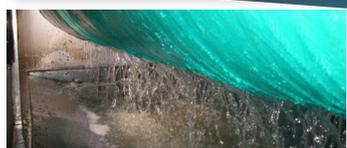
A tela do filtro tem longa duração já que não fica sob tensão de tração por ser fixada diretamente no parafuso. Combinados com a estrutura simples e robusta da máquina, esses adensadores se tornam extremamente confiáveis.
