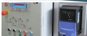
Este design permite controle simples do processo de adensamento com ajuste da velocidade rotativa que permite aumento/redução do tempo de retenção para se atingir o adensamento ideal.
