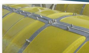
O SCRUFILTER® contém muitas placas-filtro, de forma que, se uma placa estiver danificada, será necessário trocar apenas uma, com significativa redução de custo. A troca da placa-filtro pode ser feita sem retirar o tambor da estrutura. O resultado final é uma unidade compacta de alta capacidade.
